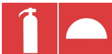
Figur 6. Skylt som visar brandsläckare till vänster och "annan brandskyddsutrustning" såsom brandfilt till höger.
